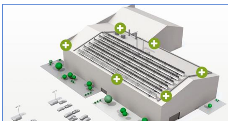
FIGURE 44 : CHAUFFE-EAU SOLAIRES SUR UN BATIMENT INDUSTRIEL
